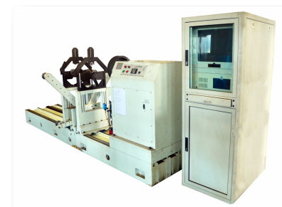
▲ 數位顯示型動力均衡試驗機 • 試驗體重量：20~300kg • 軸承最大距離：2200mm; 軸徑：130mm Digital Dynamic Balancing Machine • Weight range of work piece: 20 ~ 300kg • Distance between bearings: 2200mm; Journal diameter: 130mm
